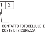
USCITA 24V (500mm) (CARICO MAX: N°2 COPPIE FOTOCELLULE N°1 RADIO RICEVENTE)
