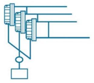
$$N \text{ motori collegati in parallelo} \leq \frac{\text{Corrente uscita fusibile (A)} \times 0,7}{\text{Corrente assorbimento motore (vedi scheda tecnica)}}$$
