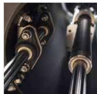
Sistema di guida lineare con cilindri in acciaio cromato
