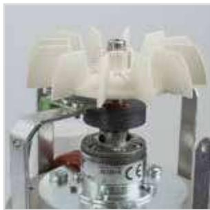
Motore con ventilazione forzata, equipaggiato con encoder
